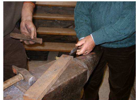
B - Usinage de la tête. Découpe au burin
