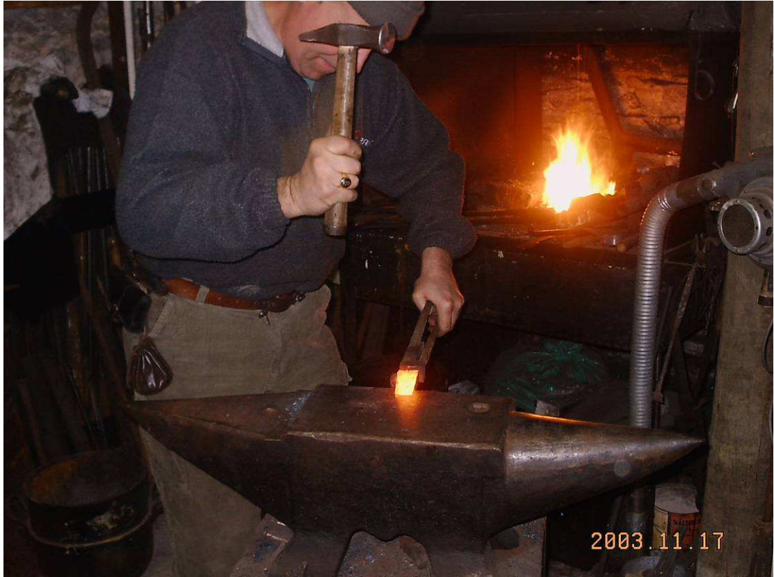
A - Etirement de la barre de fer
