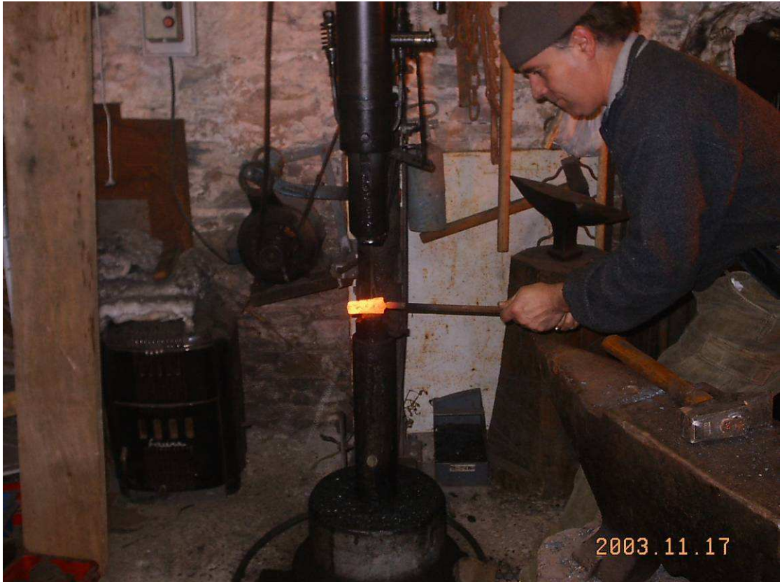
C - Etirement de la barre de fer au marteau pilon
