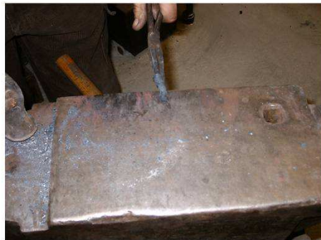
A - Préparation de la forme de la tête
