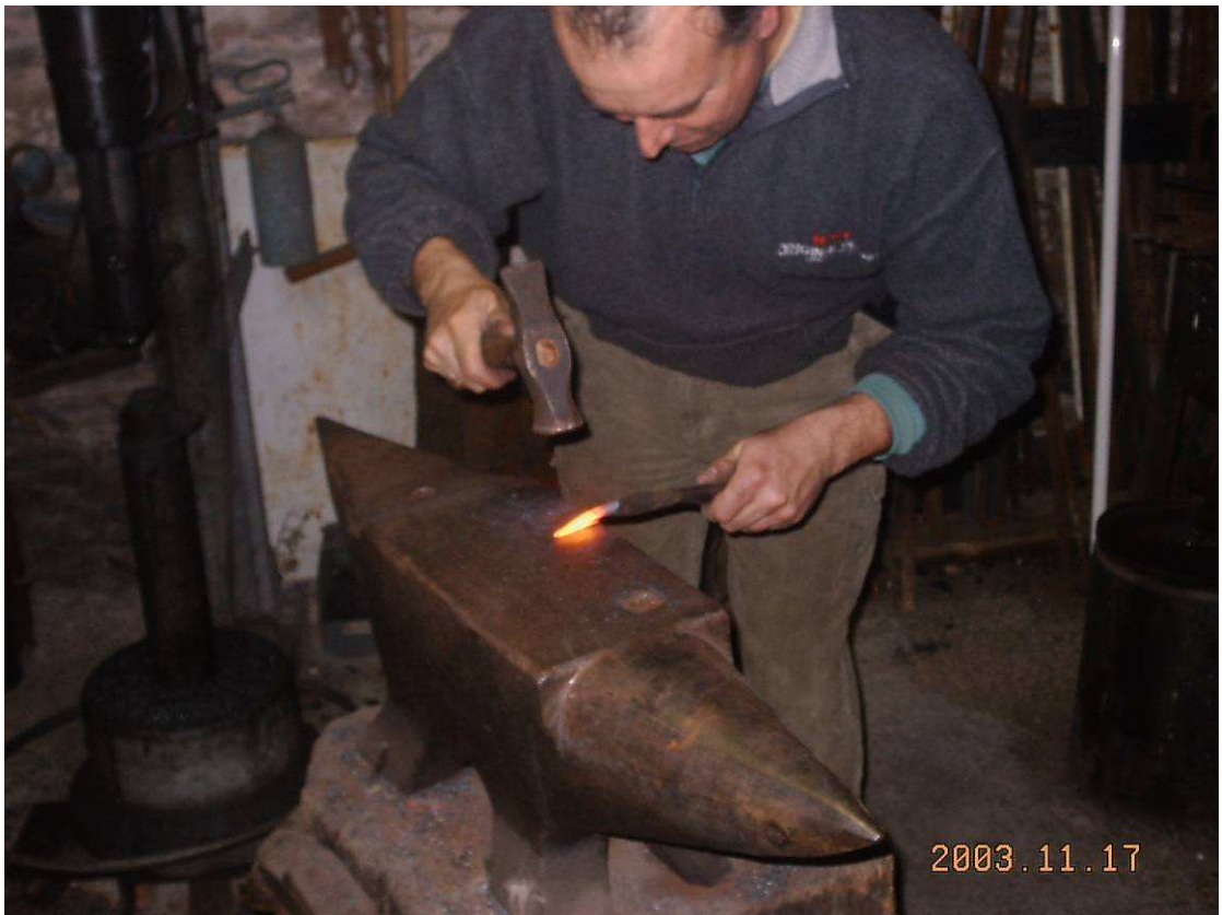
H - Fabrication de la tête de la pointe de flèche
