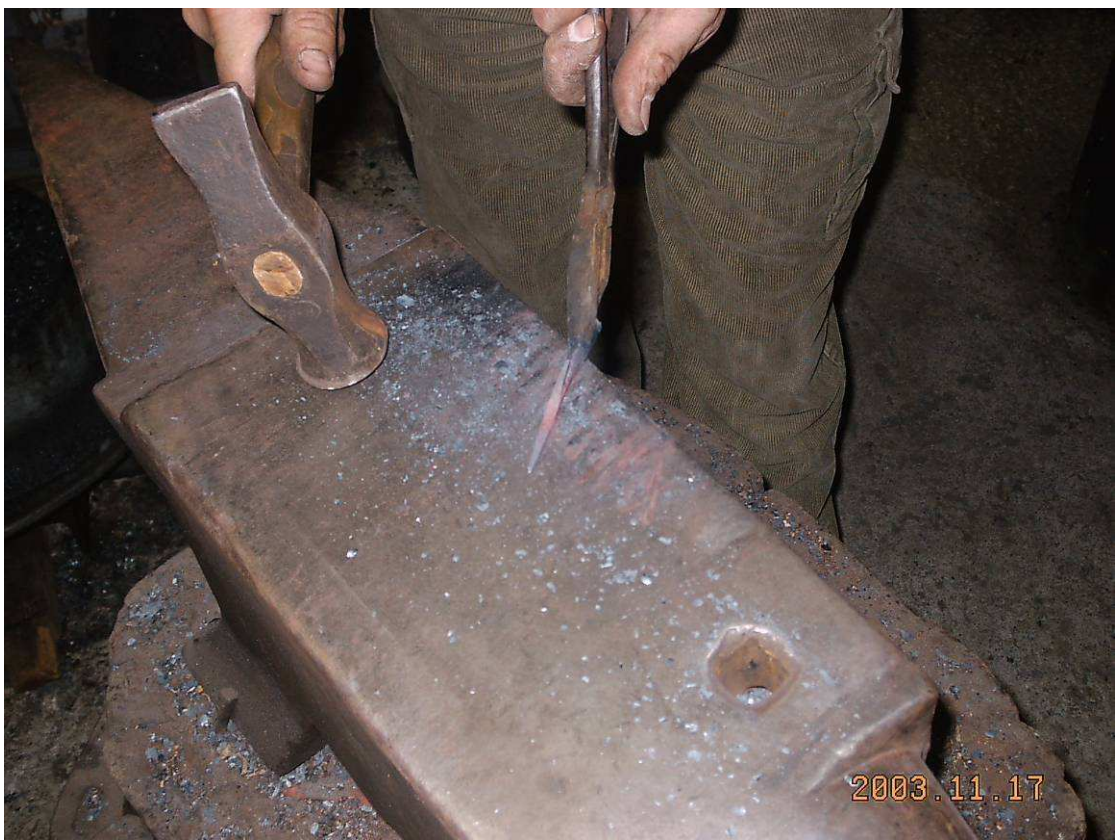
J - La pointe de flèche à une barbelure est fabriquée
